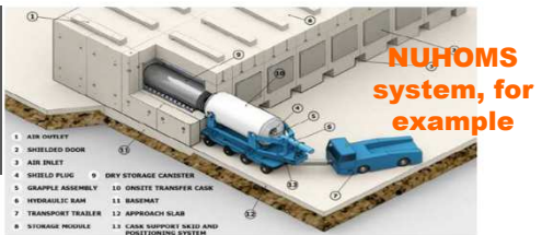
Figure n°1 : Schéma de l'entreposage à sec de type NUHOMS développé par Orano TH de San Onofre (Etats-Unis) – Source : IRSN.
